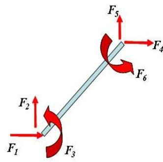
$$\begin{Bmatrix} f_1 \\ f_2 \\ f_3 \\ f_4 \\ f_5 \\ f_6 \end{Bmatrix} = \begin{bmatrix} \mathbf{R} & \begin{matrix} 0 & 0 & 0 \\ 0 & 0 & 0 \\ 0 & 0 & 0 \end{matrix} \\ \begin{matrix} 0 & 0 & 0 \\ 0 & 0 & 0 \\ 0 & 0 & 0 \end{matrix} & \mathbf{R} \end{bmatrix} \begin{Bmatrix} F_1 \\ F_2 \\ F_3 \\ F_4 \\ F_5 \\ F_6 \end{Bmatrix}$$
