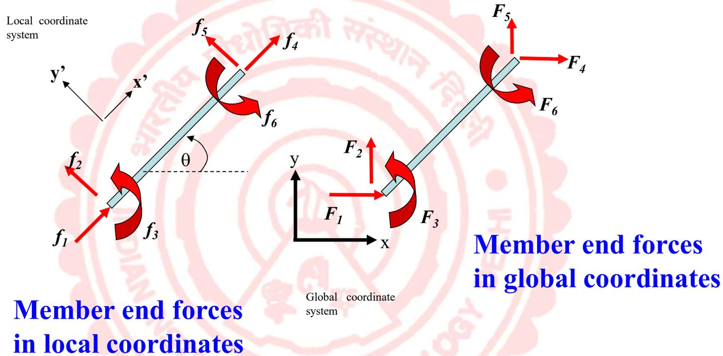
$$\begin{bmatrix} f_1 \\ f_2 \\ f_3 \end{bmatrix} = \begin{bmatrix} \cos \theta & \sin \theta & 0 \\ -\sin \theta & \cos \theta & 0 \\ 0 & 0 & 1 \end{bmatrix} \begin{bmatrix} F_1 \\ F_2 \\ F_3 \end{bmatrix}$$
