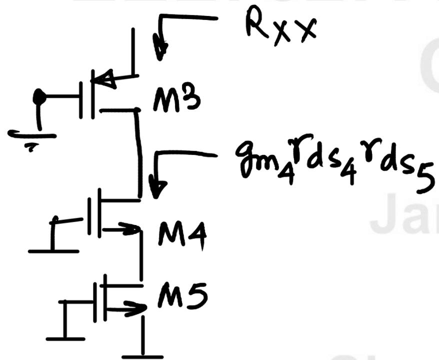
$$R_{xx} = \frac{r_{ds3} + g_{m4} r_{ds4} r_{ds5}}{1 + g_{m3} r_{ds3}}$$
